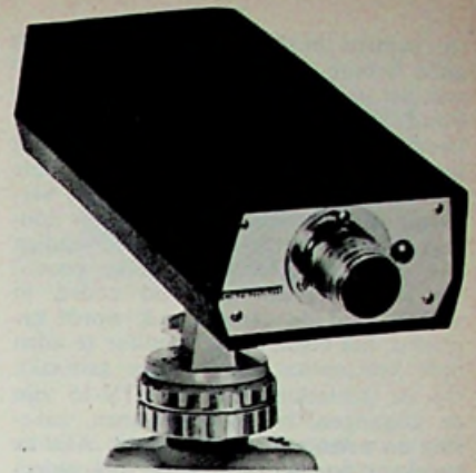
Afb. 1. De voorzijde van de ITV-15, naast het objectief een lamp voor aan/uit indicatie.
